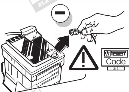
(DE) Um Störungen und Schäden am Bordnetz zu vermeiden, muss die Massepolklemme unbedingt vor Beginn aller Arbeiten von der Fahrzeughilfsbatterie getrennt werden! Insbesondere bei Arbeiten und Anschlüssen am CAN-Datenbus kann bei nicht abgeklemmter Batterie sowohl das Anhängermodul als auch das fahrzeugsseitige Bordnetzsteuergerät beschädigt werden! Bitte Herstellervorschriften beim Ab- und Anklemmen der Fahrzeughilfsbatterie beachten!
